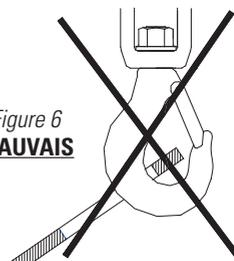
Dans le cas où le crochet destiné à saisir le palonnier se révélerait trop gros par rapport à l'œil de préhension de ce dernier, il est possible d'utiliser un accessoire intermédiaire adapté. Dans ce cas, vérifier son aptitude à recevoir la charge plus le poids du palonnier.
