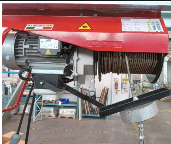
4 - Levier d'arrêt de montée, modèle à simple moufle
