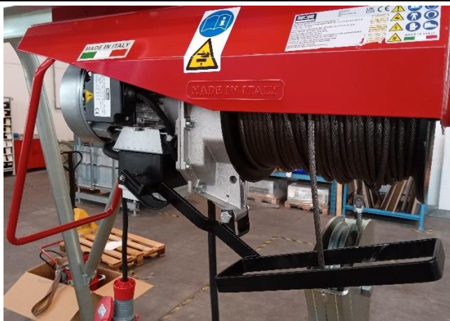
4 - Levier d'arrêt de montée, modèle à deux moufles
