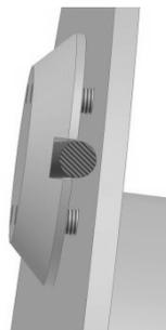
Il est possible d'équiper le TRAKZIO-R d'un câble textile au lieu d'un câble acier. Ceci nécessite un dispositif spécifique (en option) pour attacher le câble au tambour de manière sûre et efficace. La terminaison du câble textile doit former une boucle sans cosse-cœur :
