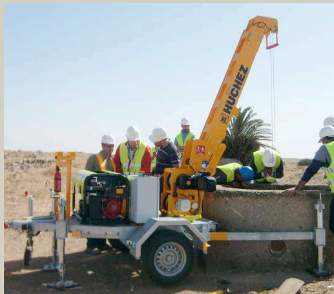
△ GMIP 140, mobiler Bohrlochinspektionskran; verwendet zum Absenken von Ingenieuren in Erkundungsbohrungen für den Bergbau, damit sie dort geologische Proben entnehmen können.
