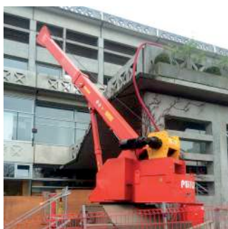
△ Am Kran eines Brunnenbauers angebrachte Winde.
