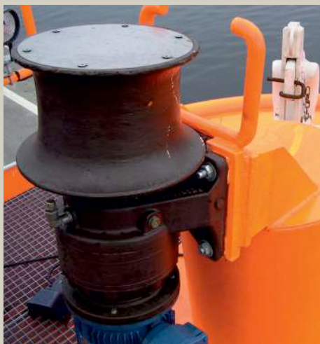
△ Spill mit Fußpedalsteuerung. Zugfähigkeit: 1,5 t. Geschwindigkeit: 25 m/min.
