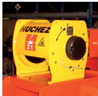
△ Die Zugstangen können entsprechend dem Drahtseilaustritt positioniert werden.
