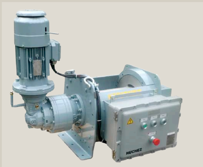
△ Hubwinde mit ATEX-Komponenten (elektrische Einheit, oberer und unterer Endschalte, Motor, Untersetzungsgetriebe).
