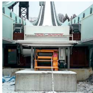
▷ Ziehen des Gewichts zum Verdichten von Schnee auf einer Sprungschanze.
