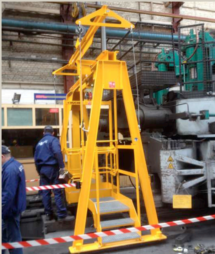
△ Ein Portalkran hält eine Gondel, die bei der Wartung eines rotierenden Laminators eingesetzt wird, in dem Triebwerkskronen hergestellt werden.
