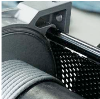
△ Trommel geschützt durch ein ausrichtbares Lochblech. Breite Flansche für hohes Seilaufnahmevermögen.
