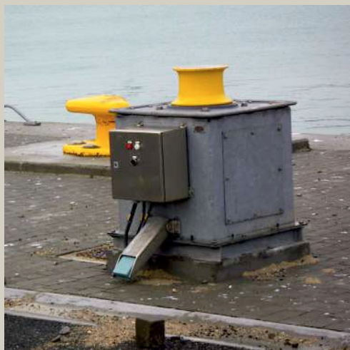
△ Spill mit Fußpedalsteuerung. Zugfähigkeit: 1,5 t. Geschwindigkeit: 25 m/min.
