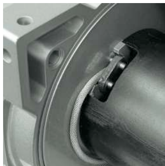
△ Abrazadera para cables muy fiable que no requiere una herramienta especial, con guía para el sentido de bobinado del cable. Tuerca en jaula para un acople sencillo.
