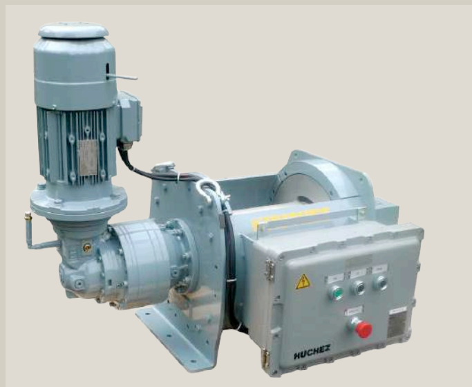
△ Cabestrante de elevación con componentes ATEX (unidad eléctrica, interruptor de límite superior e inferior, motor, engranaje reductor).
