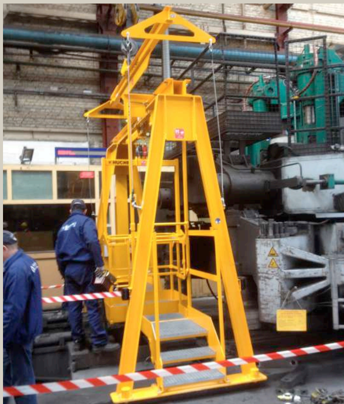
△ Grúa pórtico con una góndola utilizada durante el mantenimiento de una laminadora giratoria para fabricar coronas de motores a reacción.
