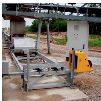
▶ Tensado de la cinta transportadora.
