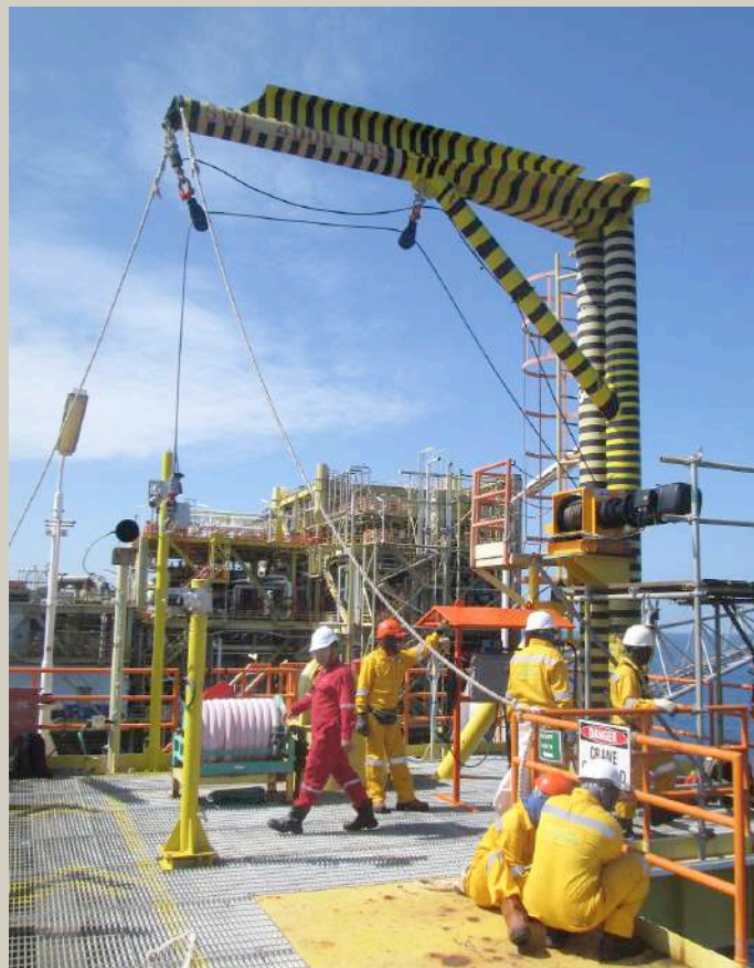
△ Cabestrante de elevación ATEX utilizado en una plataforma petrolífera.
