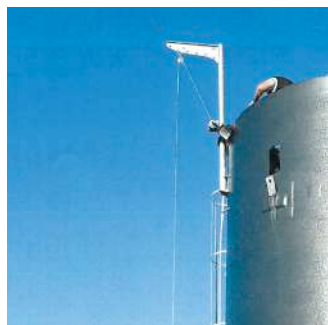
△ Grúa torre con cabestrante manual TIREX.
