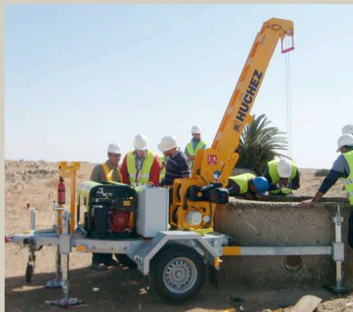
△ GMIP 140, Grúa móvil para inspección de pozos, que se usa para hacer descender a los ingenieros responsables de tomar muestras biológicas en pozos exploratorios para la minería.
