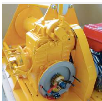
△ Reductor – inductor – Freno.
