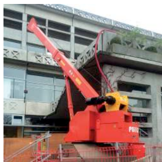
△ Cabestrante instalado en una grúa de excavación de pozos.
