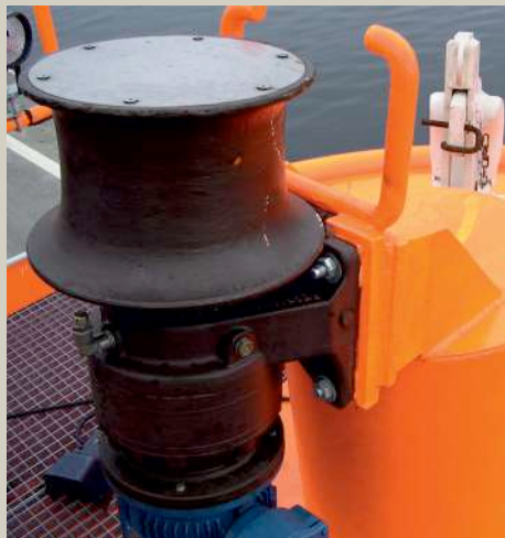
△ Cabestrante con control mediante pedal. Capacidad: 1,5 t. Velocidad: 25 m/min.
