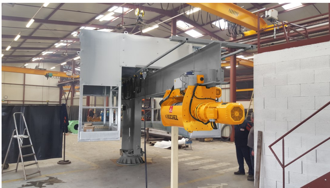
Le treuil HUCHEZ en atelier lors de son installation sur la potence
