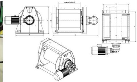
Treuil électrique 10000 kg. Gamme de treuils électriques dotés d'une grande capacité d'enroulement de câble et développés pour répondre à des utilisations intensives en environnement sévère pour les applications de levage et traction/halage.
